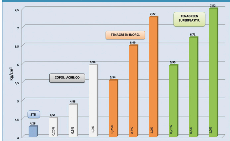
FIG. 1. TENAGREEN INORGANIC AND SUPERPLASTICISER: EXPERIMENTAL RESULTS FOR GREEN MOR Tenagreen inorganico e superplastificante: risultati sperimentali relativi al MOR in verde
